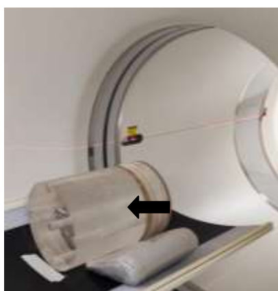
Figura 1: Filme radiocrômico, indicado pela seta preta, posicionado no interior do objeto simulador.
