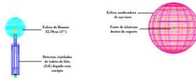
Figura 2: Modelo representativo da simulação com sistema montado a 1 metro do detector
