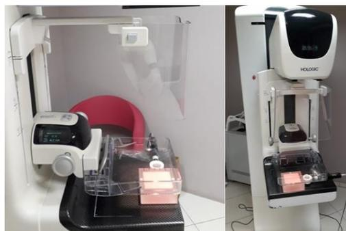
Figura 1 - Posicionamento da câmara de ionização e do *phantom*.
