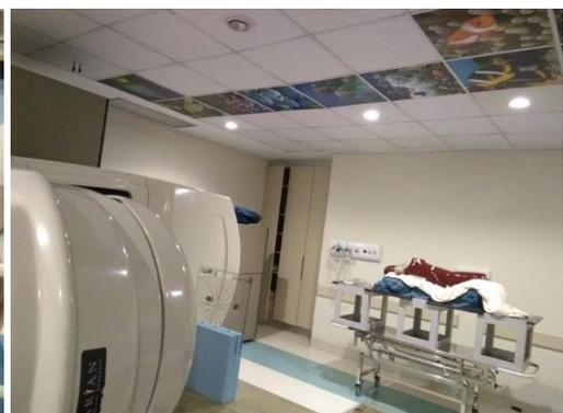
Figura 1: à esquerda, bolsas de soro fisiológico sobre o *phantom*, deitado em posição de tratamento; à direita, o *phantom* posicionado na sala do acelerador linear.
